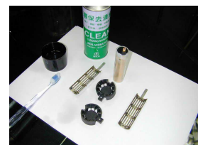
④ 最後に電極板を洗い乾かします。
